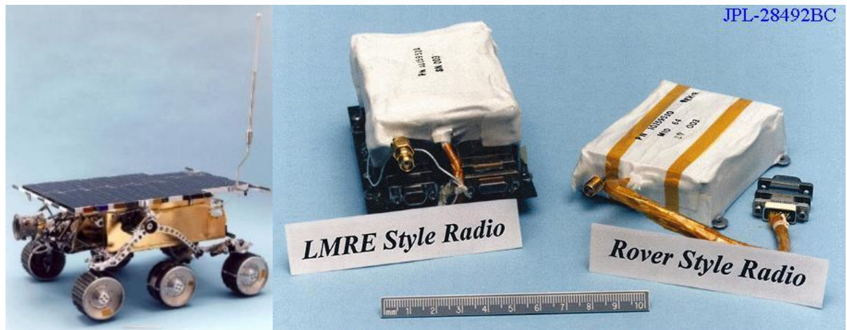
Рис. 1. Марсоход «Марс Пасфайндер» и применявшиеся в интересах управления и мониторинга технического состояния на борту марсохода и посадочного модуля радиомодемы RNet9600. (Фото из архива канадской компании Dataradio).
