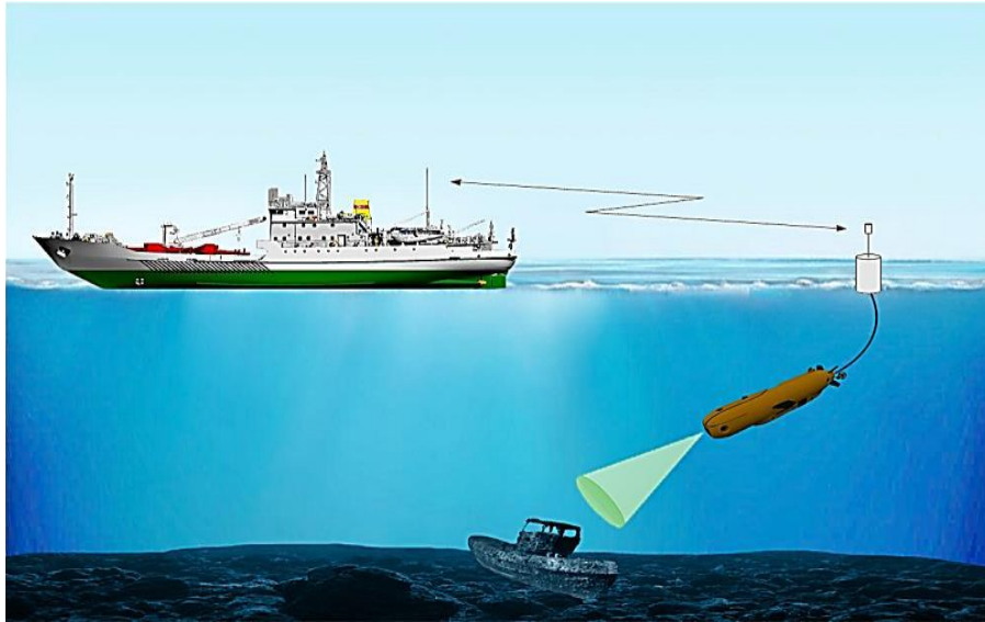
Рис. 2. Вариант организации управления работой ТНПА с использованием радиоканала
