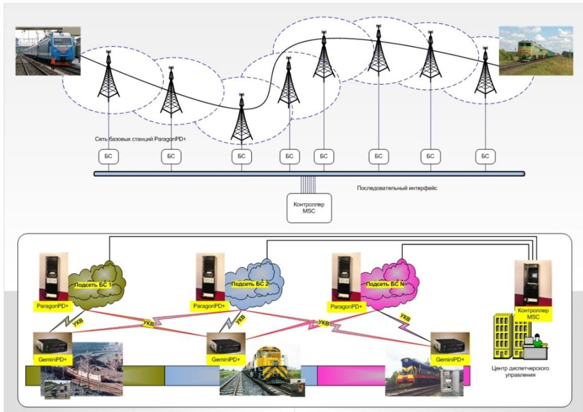
Рис. 1 Схема конвенциональной технологической радиосети обмена данными для системы управления движением на железнодорожном транспорте на базе радиомодемов Paragon<sup>PD+</sup>/Gemini<sup>PD+</sup>.
