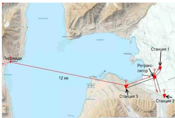
Рис. 2. Общая схема радиосети для инструментального мониторинга состояния ледника Норденшельда – арх.Шпицберген.
