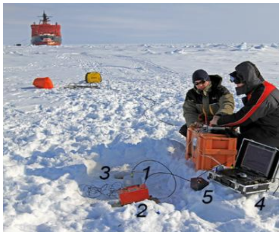
Рис. 1. Схема размещения приборов на ровном льду при экспериментах с движением ледокола «Ямал». Размещение оборудования на пикете: 1 – сейсмометр, 2 – наклономер, 3 – деформометр, 4 – регистратор, 5 – набор аккумуляторов, (радиомодем с антенной за кадром).
