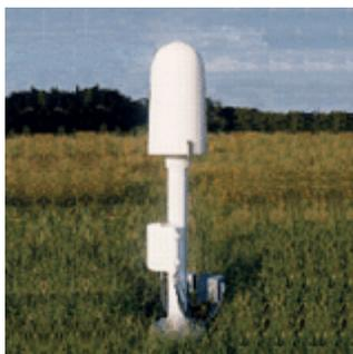
Рис. 1. Общий вид устройства автоматической пеленгации грозовых разрядов ALDF.
