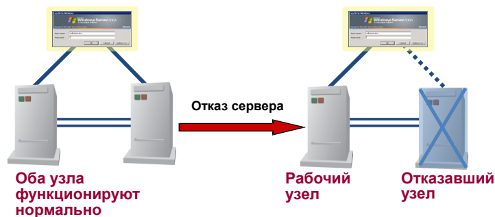
Рис. 9. Схема реализации информационной системы третьего уровня отказоустойчивости (при выходе из строя вычислительного узла).
