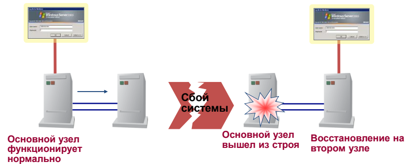
Рис. 6. Схема реализации информационной системы первого уровня отказоустойчивости.
