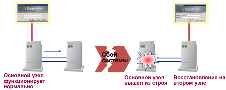
Рис. 8. Схема реализации информационной системы второго уровня отказоустойчивости (при выходе из строя вычислительного узла).
